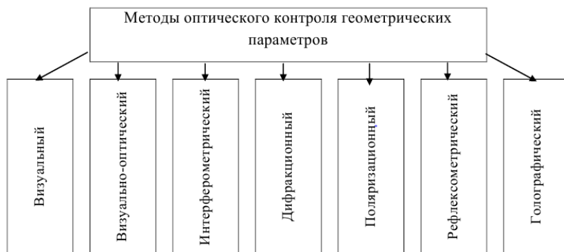
Рис. 2. Методы оптического контроля геометрических параметров
