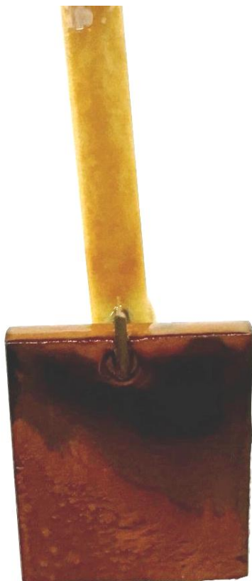
Рис. 1. Внешний вид образца после взаимодействия с агрессивной средой без ингибитора
