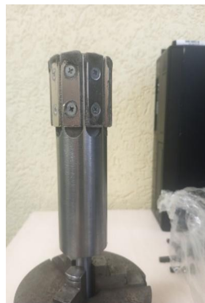
Рис. 2. Магнитопроводящая оправка для обработки бронзовых вкладышей подшипников скольжения:
