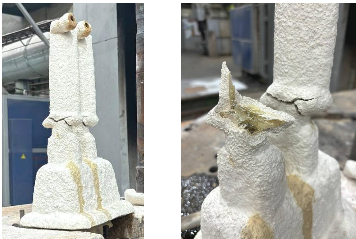
Рис. 3. Растрескивание огнеупорной керамической формы в процессе удаления комбинированного модельного блока
