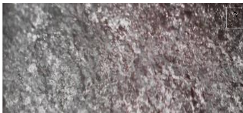
Рис. 4. Излом слитка серого чугуна марки СЧ 20
