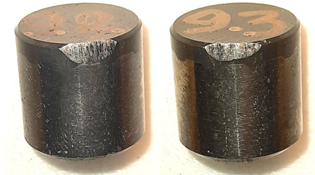
Рис. 2. Вид изношенного участка PDC-резцов класса 20ДТВ при триботехнических испытаниях по схеме «кромка зубка – алмазный диск»
