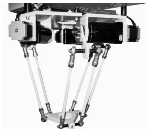
Рис. 7. Общий вид и схема конструкции манипулятора трипода
