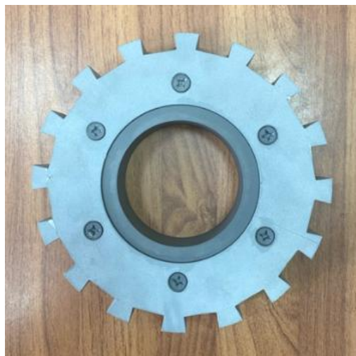
Рис. 1. Оправка прерывистого шлифовального круга для 16 режущих сегментов
