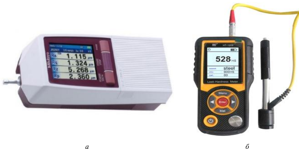
Рис. 1. Лабораторные приспособления, использованные в экспериментальных исследованиях: а – профилометр Mitutoyo SJ-210; б – твердомер НТИ НТ-1208
